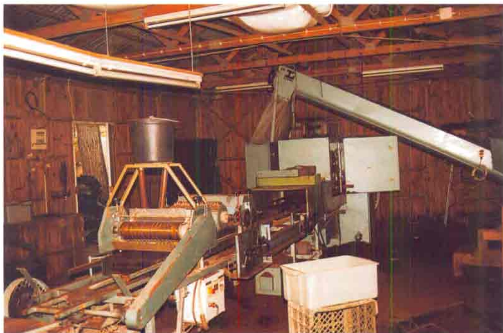
Foto 9 – Linha de sementeira. A primeira máquina deste género a ser utilizada em viveiros florestais em Portugal (viveiro das Estufas – Amarante – Direcção Regional de Agricultura do Entre Douro e Minho)
