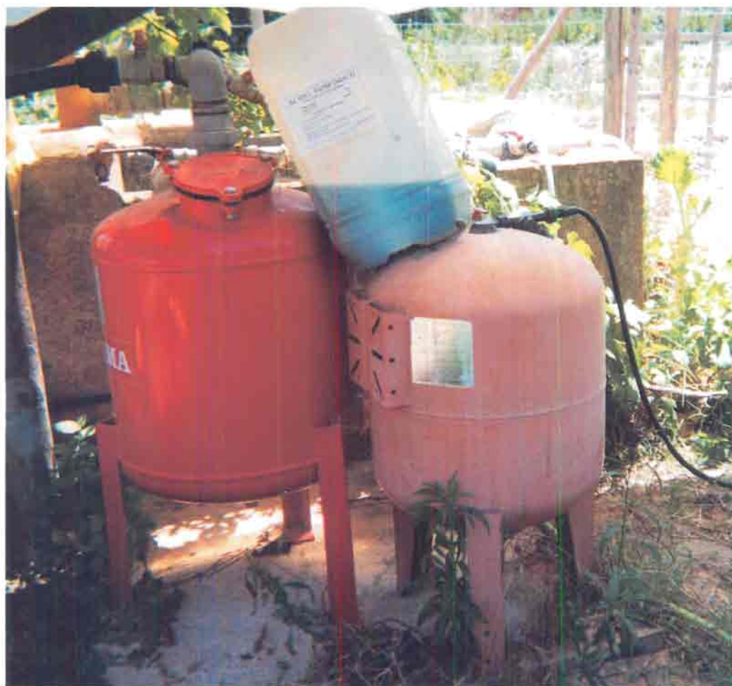
Foto 12 – Misturador de adubos num sistema de rega no viveiro florestal de Monte Gordo (Direcção Regional de Agricultura do Algarve)
