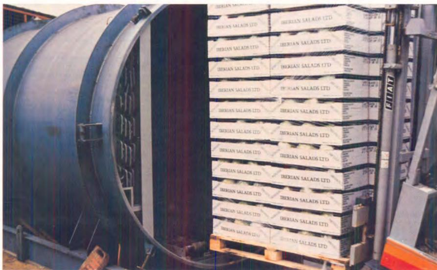
Foto n.º 19 — Alfaces devidamente acondicionadas a darem entrada na câmara da «Vacuum-cooling»
