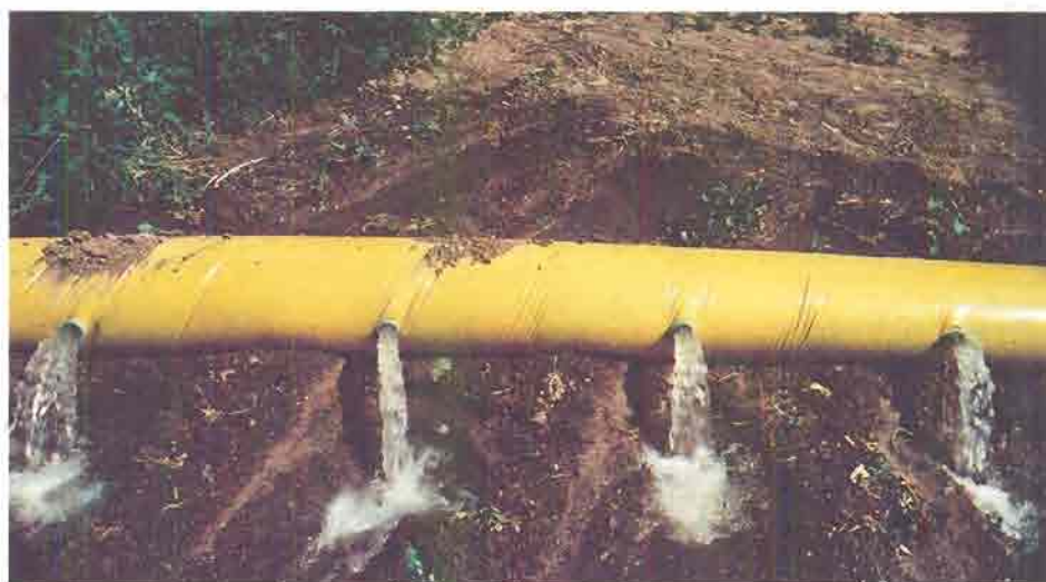
Alimentação de sulcos por meio de uma manga de plástico com orifícios calibrados.
