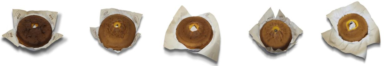
Fig. Gama admissível de cor da superfície superior
